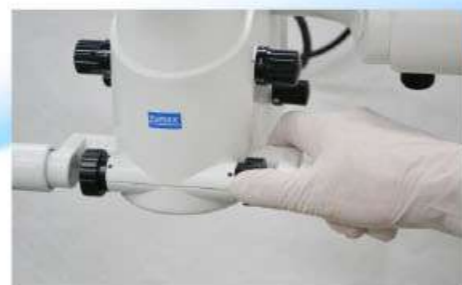
پیچ تنظیم فوکوس دقیق Fine Focus
